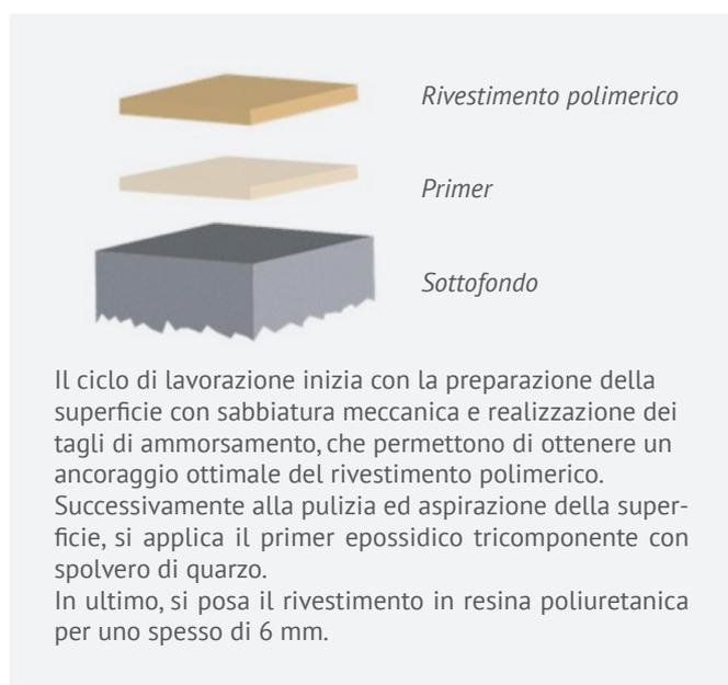
In corrispondenza della giunzione con la canalina ed il tombino di scolo, il sottofondo in calcestruzzo è stato scarificato in prossimità delle quote fisse al fine di ottenere uno spessore costante del rivestimento che mira a mantenere saldo il poliuretano cemento al sottofondo ed in presenza di acqua far in modo che non si creino infiltrazioni.
